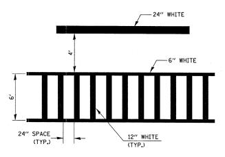
TYPICAL SPACING DETAIL FOR **CROSSWALKS AND STOP BARS** ON IL RTE 72
