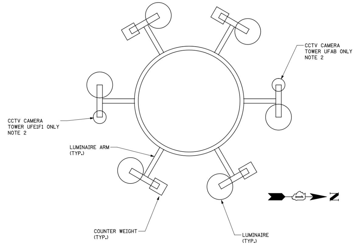
**LIGHT TOWER LUMINAIRE RING DETAIL (TYP.)**
