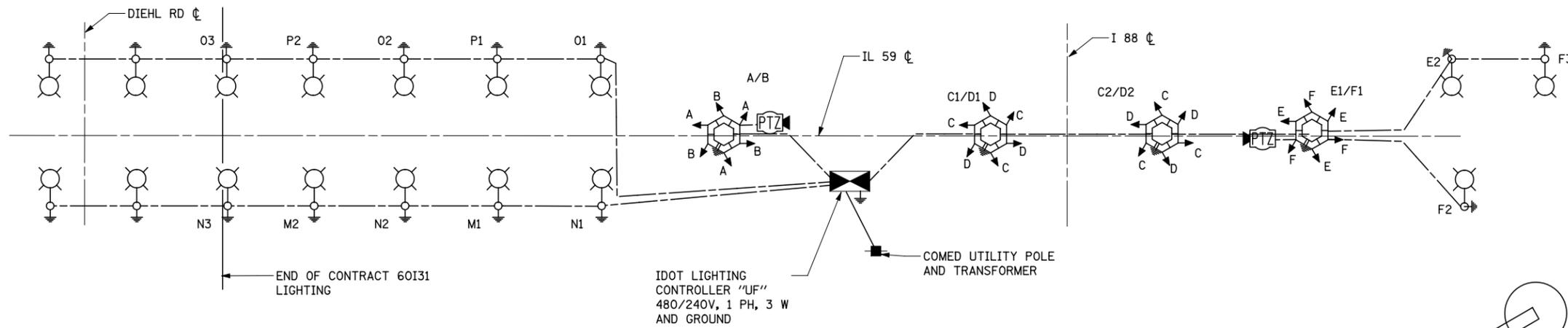
**IDOT LIGHTING CONTROLLER "UF" SINGLE LINE DIAGRAM**
