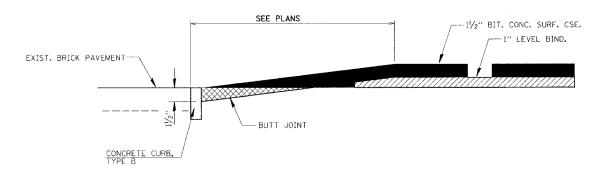
**BUTT JOINTS, SPECIAL DETAIL**
