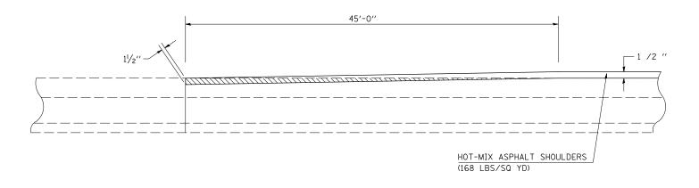
HOT-MIX ASPHALT SURFACE REMOVAL - BUTT JOINT
