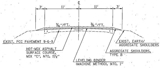
PAVING OMISSION AT MAIN ST: STATION 998+50 TO STATION 999+54
