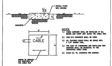
TURF CABLE MARKER DETAIL
