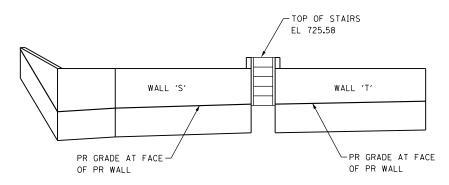
SEGMENTAL CONCRETE BLOCK WALL ELEVATION
