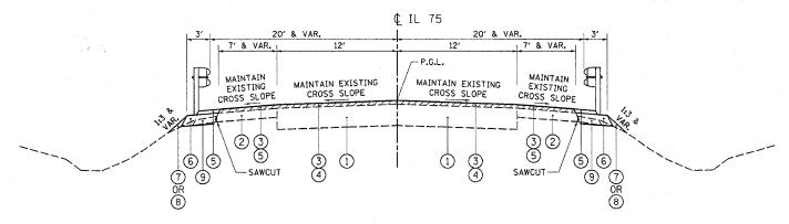
SAWCUT ALONG EDGE OF SHOULDER TO REMAIN PRIOR TO REMOVING PAVED SHOULDER (WORK INCLUDED IN THE CONTRACT PRICE PER SQUARE YARD FOR PAVED SHOULDER REMOVAL).
