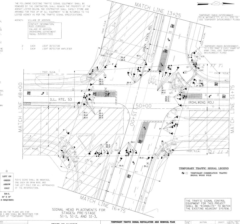
NOTE: THE VIDEO DETECTION ZONES SHOWN ON THE PLANS ARE FOR CONSTRUCTION STAGE 1 - SUBSTAGE 1 AND SHALL BE REDEFINED FOR EACH CONSTRUCTION STAGE AS A PART OF "TEMPORARY TRAFFIC SIGNAL INSTALLATION" WORK.
