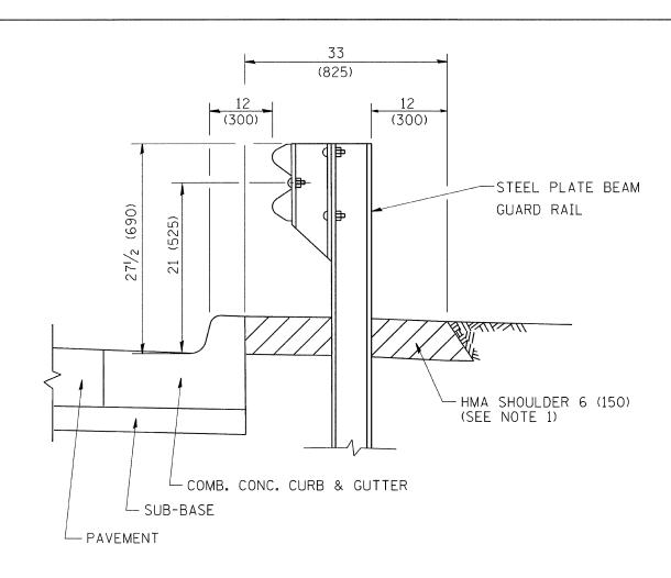
NOTES: 1. THE HMA SHOULDER SHALL EXTEND UNDER THE TRAFFIC BARRIER TERMINAL
