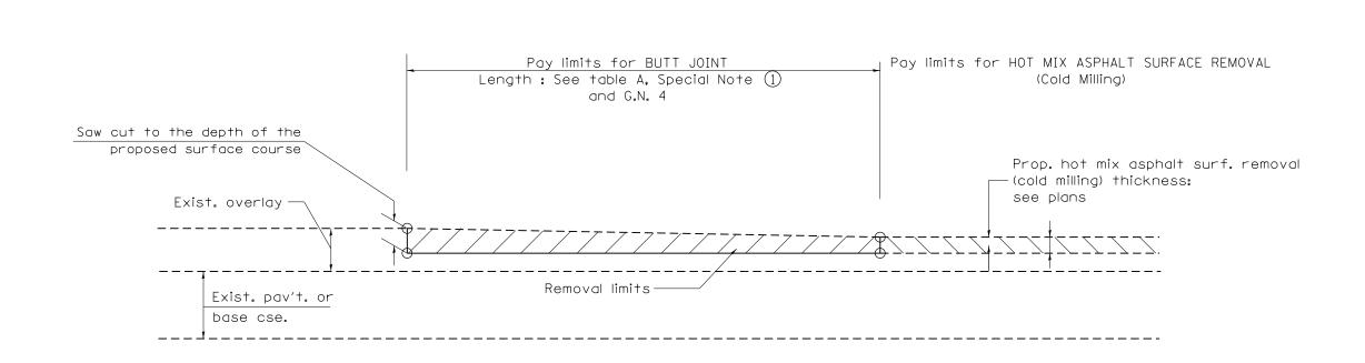
CASE 4: NO HOT MIX ASPHALT SURFACE REMOVAL (COLD MILLING)
