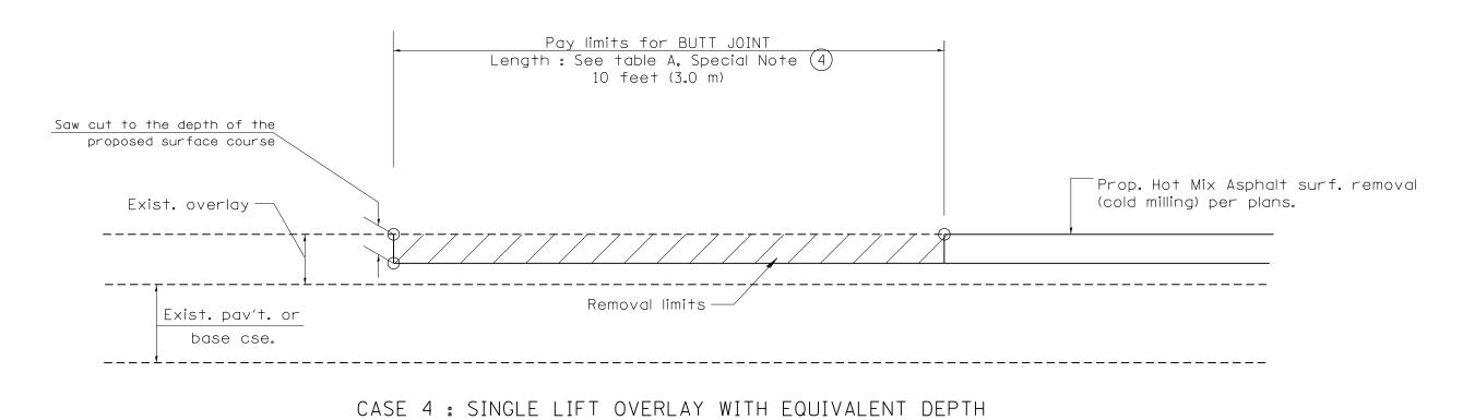
HOT MIX ASPHALT SURFACE REMOVAL (COLD MILLING)
