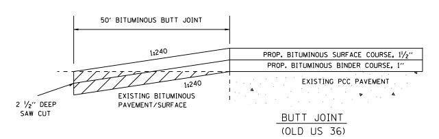
NOTE: TO BE PAID FOR AS BITUMINOUS SURFACE REMOVAL - BUTT JOINT.
