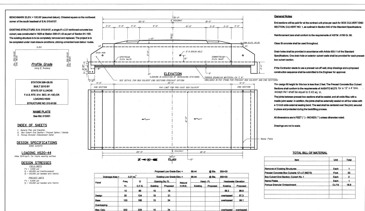
**GENERAL PLAN AND ELEVATION** SINGLE 12' x 2' PRECAST BOX CULVERT F.A.S. ROUTE 514 - SECTION 81-15D.CR **CHAMPAIGN COUNTY** STATION 356+28.00, S.N. 010-8130
