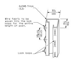
ROLL FORMED SECTION OF TERMINAL & GATE POST
