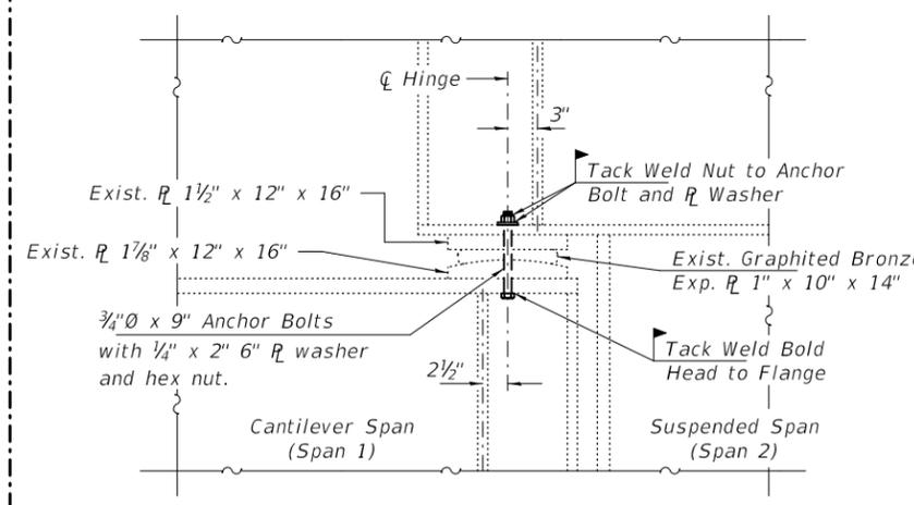
**ELEVATION AT HINGE #1**
