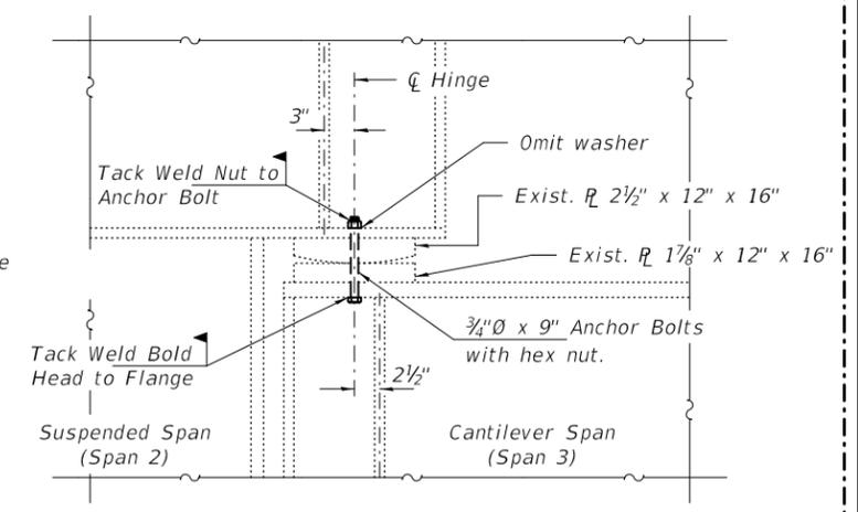
**ELEVATION AT HINGE #2**
