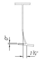
**EXISTING DEFORMATION TO BE STRAIGHTENED**
