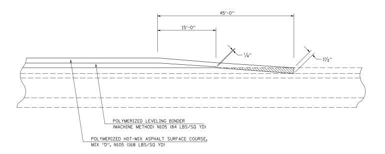
HOT-MIX ASPHALT SURFACE REMOVAL - BUTT JOINT
