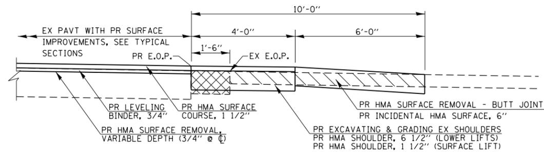
**SECTION F-F FOR EX HMA PE**
