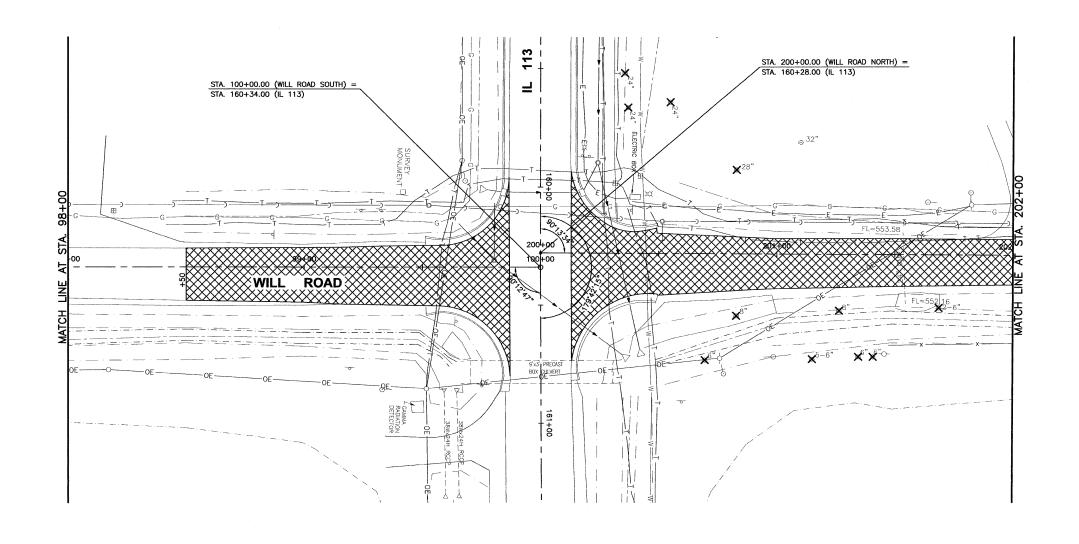
HOT-MIX ASPHALT SURFACE REMOVAL, BUTT JOINT
