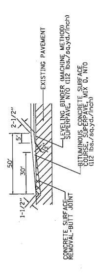
BITUMINOUS BUTT JOINT
