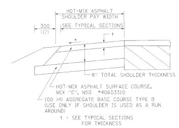
THE HOT-MIX ASPHALT SHOULDER SHALL BE CONSTRUCTED IN ACCORDANCE WITH SECTION 482 EXCEPT THE TOP LIFT SHALL BE HOT-MIX ASPHALT SURFACE COURSE, MIX "C", N50 #40603310. THE WORK WILL BE PAID FOR AT THE CONTRACT UNIT PRICE PER TON FOR HOT-MIX ASPHALT SURFACE COURSE, MIX "C". N50 #40603310 AND SQUARE YARD FOR HOT-MIX ASPHALT SHOULDERS OF THE THICKNESS SPECIFIED.
