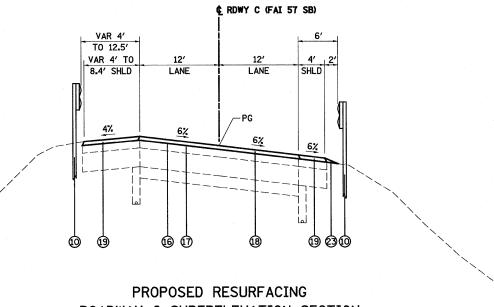
ROADWAY C SUPERELEVATION SECTION
