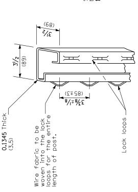
ROLL FORMED SECTION OF TERMINAL & GATE POST
