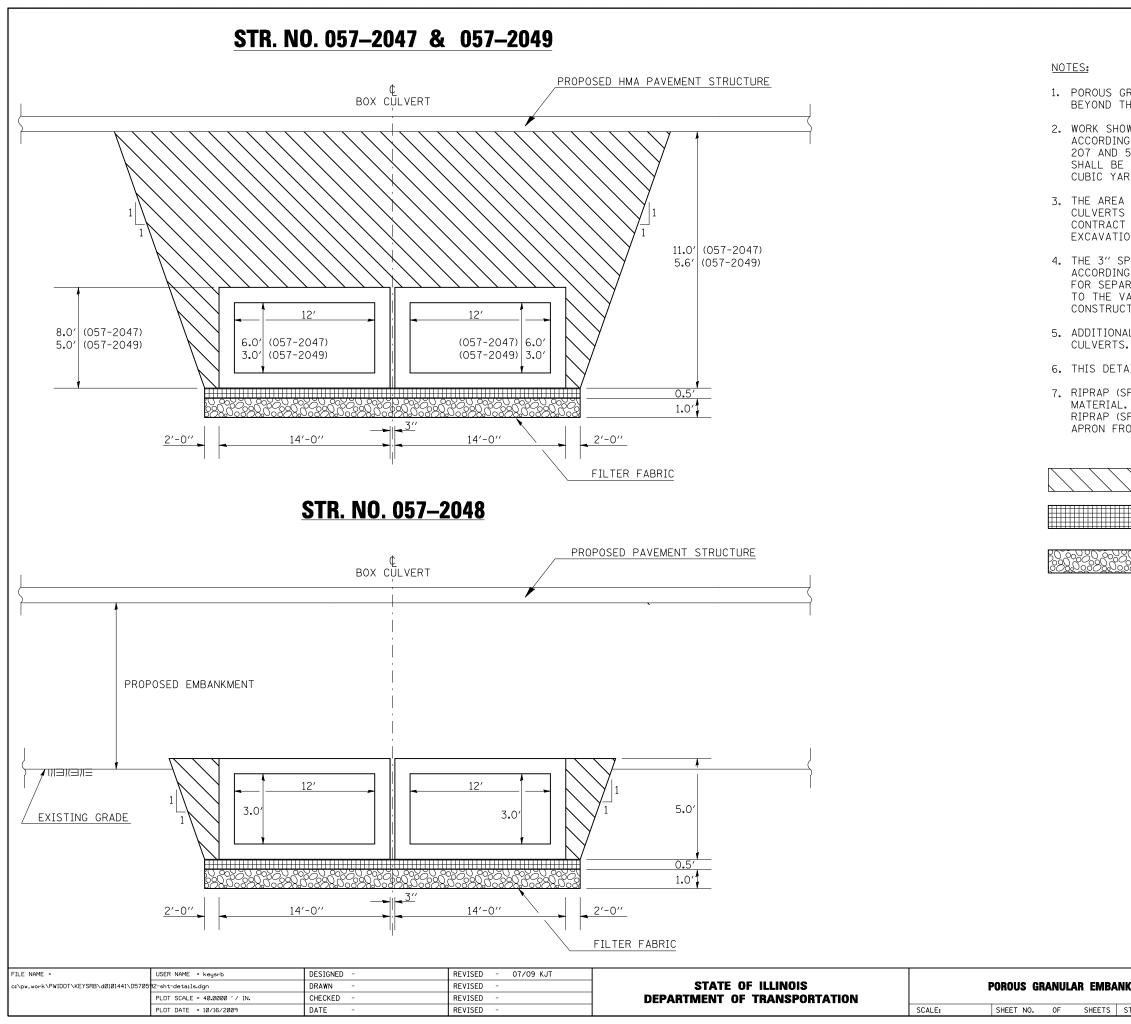
1. POROUS GRANULAR EMBANKMENT SHALL EXTEND 2'-0" BEYOND THE AGGREGATE OR EARTH SHOULDER.
