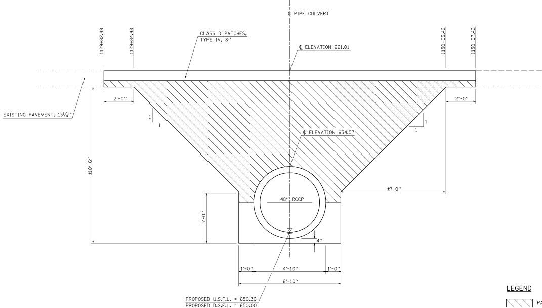
PAY LIMITS OF POROUS GRANULAR BACKFILL - CA-6
