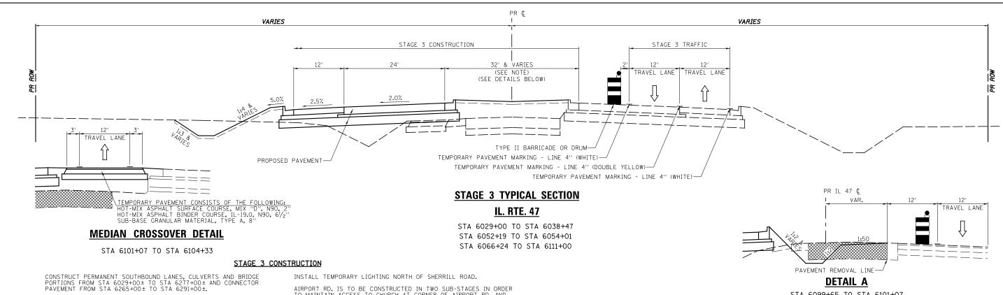
THE SEGMENT FROM STA 6040+00± TO STA 6050+00± SHALL BE CONSTRUCTED IN A MANNER TO ENSURE ACCESS TO THE SCHOOL IS OPEN AT ALL TIMES. THE CONTRACTOR SHALL SCHEDULE THE WORK OPERATIONS ALONG THIS SEGMENT IN A MANNER TO ENSURE TRAFFIC IS NOT EXPOSED TO AN EDGE OF PAVEMENT DROP-OFF DESCRIBED UNDER TRAFFIC CONTROL AND PROTECTION NOTES.
