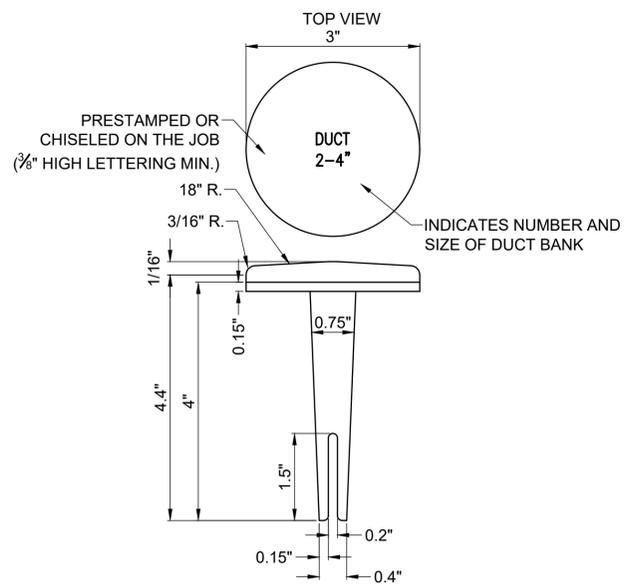
**BITUMINOUS PAVEMENT DUCT MARKERS**
