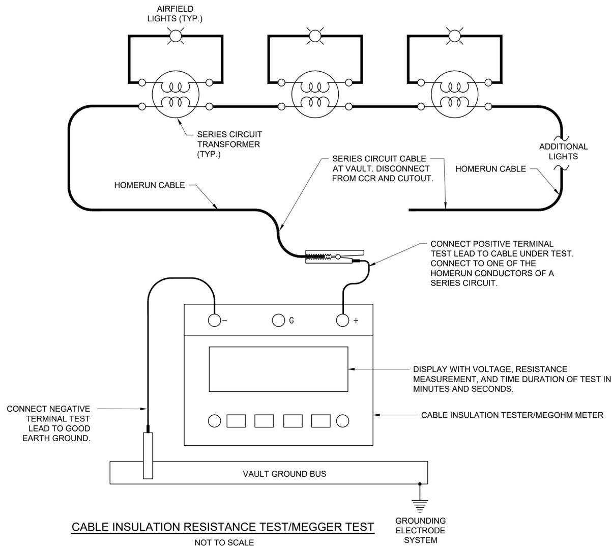
**CABLE INSULATION RESISTANCE TEST/MEGGER TEST**
