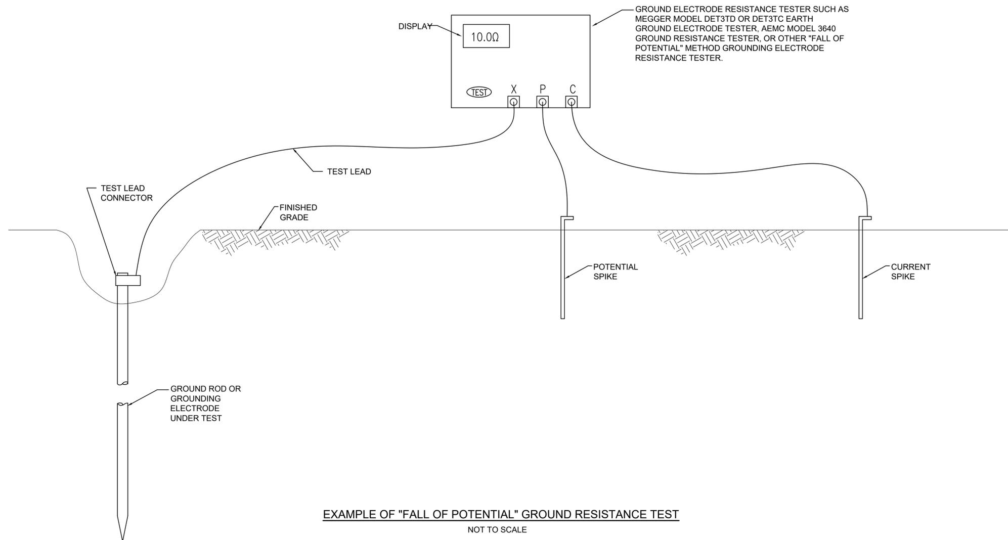
**EXAMPLE OF "FALL OF POTENTIAL" GROUND RESISTANCE TEST**
