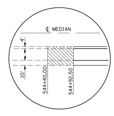
HOT-MIX ASPHALT SURFACE REMOVAL - BUTT JOINT
