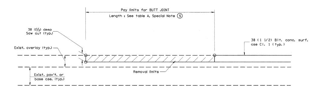
CASE 5: WITH BITUMINOUS SURFACE REMOVAL (COLD MILLING) TIE-IN TO EXISTING BITUMINOUS TAPER
