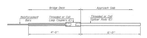
ROLLED THREAD DOWEL BAR
