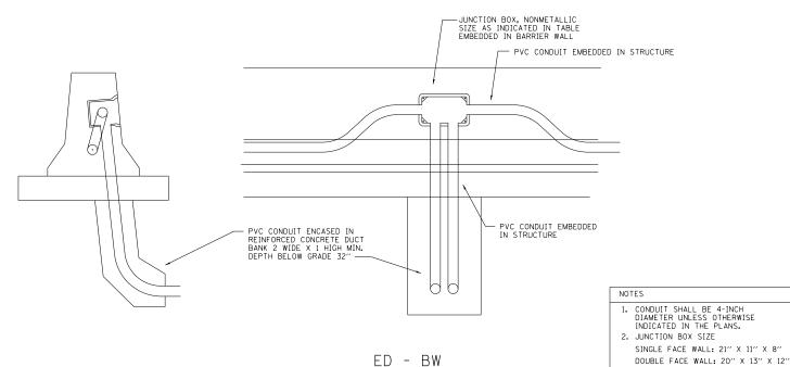
JUNCTION BOX EMBEDDED IN BARRIER WALL
