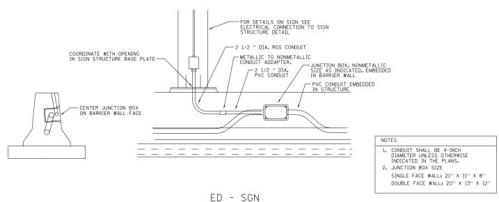
JUNCTION BOX EMBEDDED IN BARRIER WALL FOR SIGN LIGHTING
