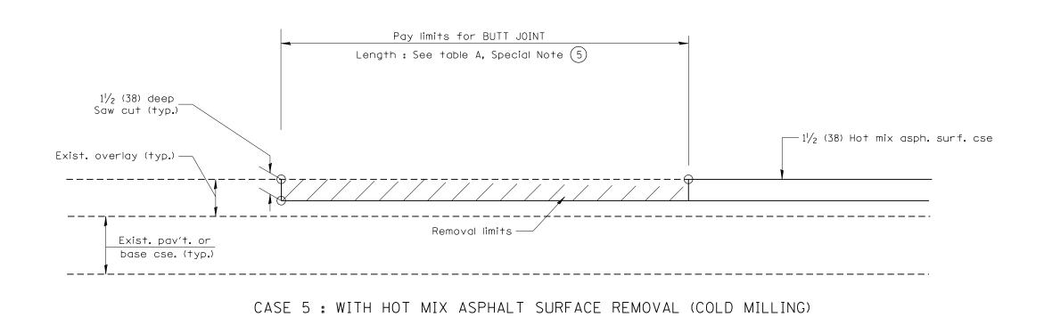
TIE-IN TO EXISTING BITUMINOUS TAPER
