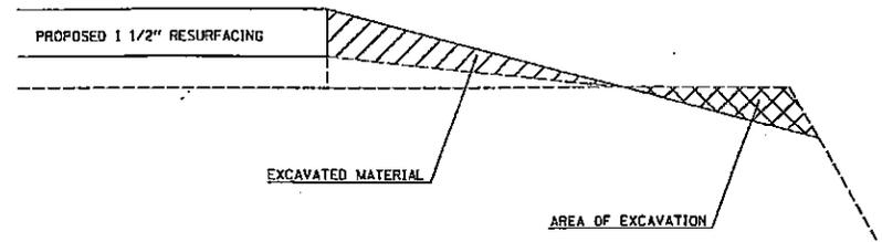
NOTE: THE STONE AND EARTH SHOULDERS OUTSIDE THE BITUMINOUS CONCRETE SURFACE COURSE, SUPERPAVE SHALL BE GRADED AS SHOWN IN THE DETAIL.
