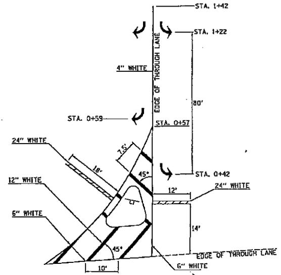
**BUTT JOINT DETAIL FOR ILLINOIS 130**
