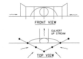
UPSTREAM PIPE CULVERT EROSION CONTROL
