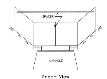
EROSION CONTROL AT OPEN GRATE MAN HOLE
