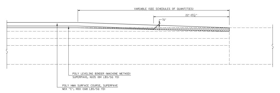
BITUMINOUS SURFACE REMOVAL - BUTT JOINT
