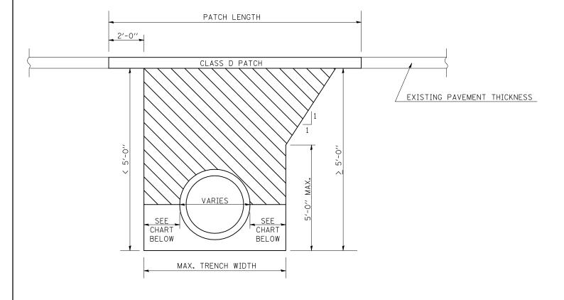
PAY LIMITS OF POROUS GRANULAR BACKFILL - CA-6
