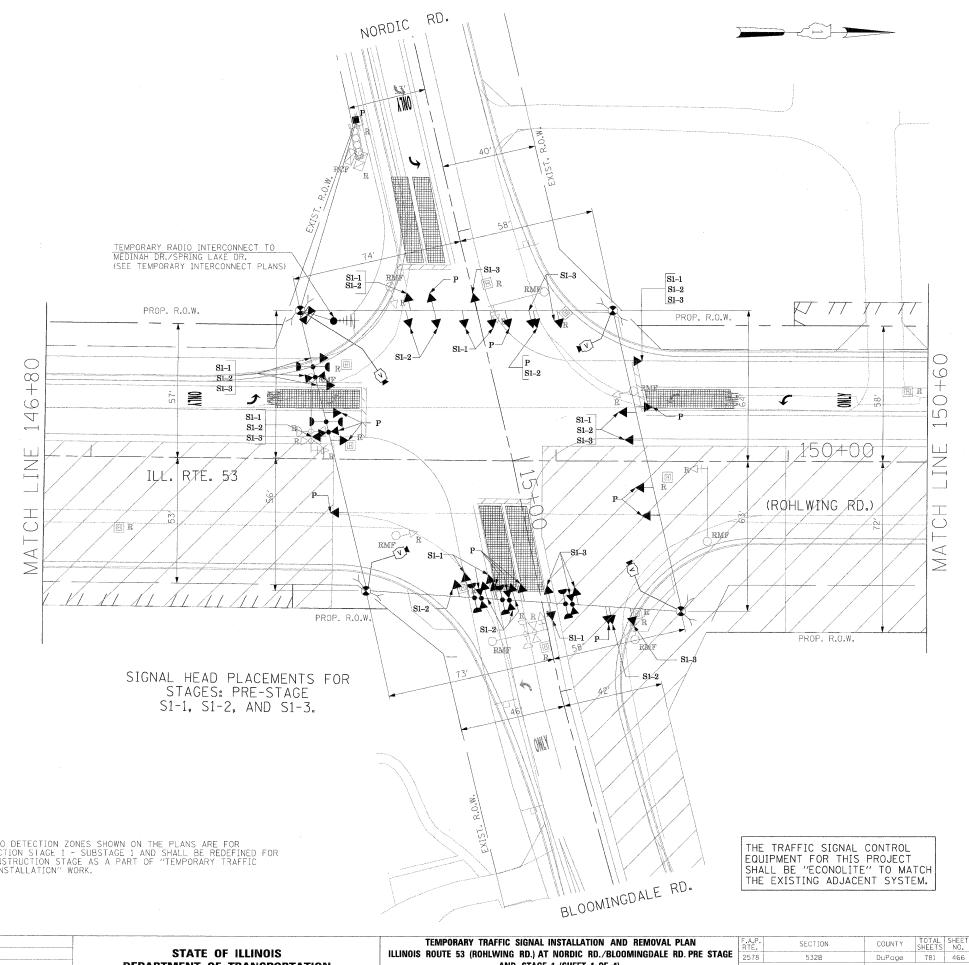
NOTE: THE VIDEO DETECTION ZONES SHOWN ON THE PLANS ARE FOR CONSTRUCTION STAGE 1 - SUBSTAGE 1 AND SHALL BE REDEFINED FOR EACH CONSTRUCTION STAGE AS A PART OF "TEMPORARY TRAFFIC SIGNAL INSTALLATION" WORK.
