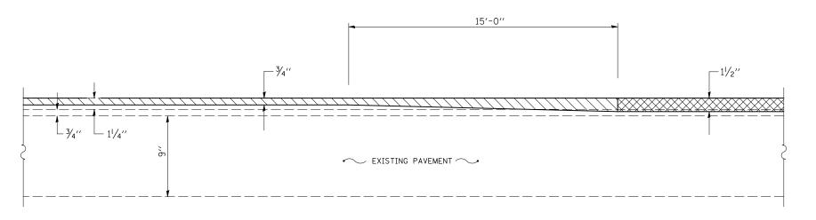
BITUMINOUS SURFACE REMOVAL, 11/2"
