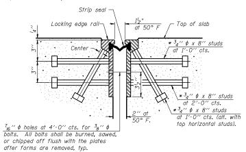
PREFORMED JOINT STRIP SEAL DETAIL
