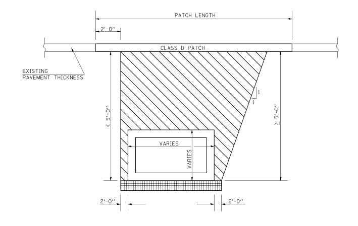
\* POROUS GRANULAR BACKFILL SHALL EXTEND 5'-0'' OUTSIDE OF THE EDGE OF SHOULDER.
