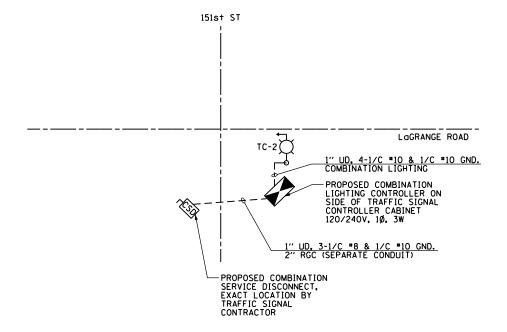
COMBINATION LIGHTING CONTROLLER "ZV" STAGE 1 WIRING DIAGRAM
