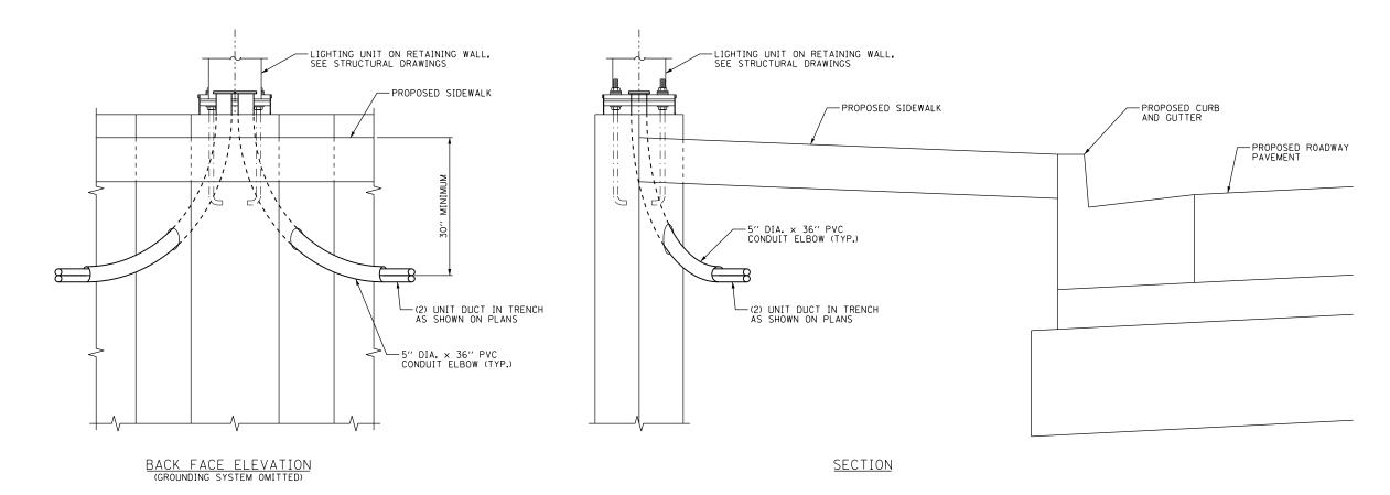
LIGHT POLE ON CAST-IN-PLACE RETAINING WALL N.T.S.
