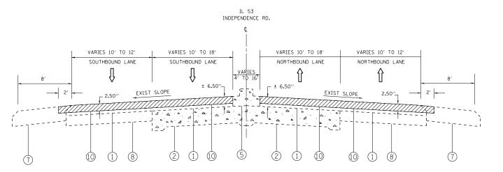
IL 53 (INDEPENDENCE RD) EXISTING TYPICAL SECTION STA. 4+58 TO STA. 14+49
