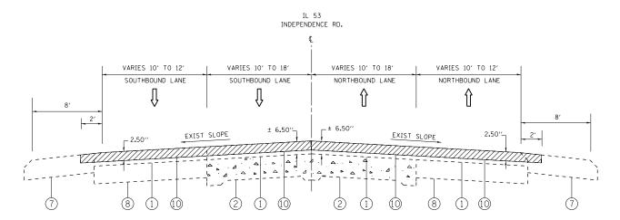
IL 53 (INDEPENDENCE RD) EXISTING TYPICAL SECTION STA. 60+00 TO STA. 73+67 STA. 114+53 TO STA. 127+20
