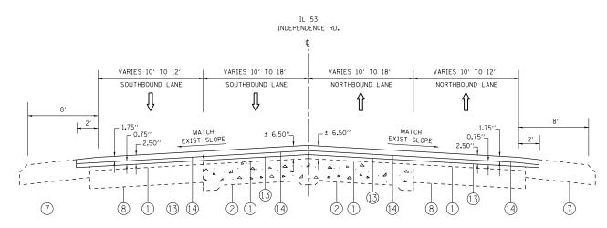
IL 53 (INDEPENDENCE RD) PROPOSED TYPICAL SECTION STA. 60+00 TO STA. 73+67 STA. 114+53 TO STA. 127+20
