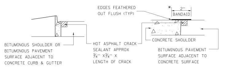
CRACK & JOINT SEALING DETAIL
