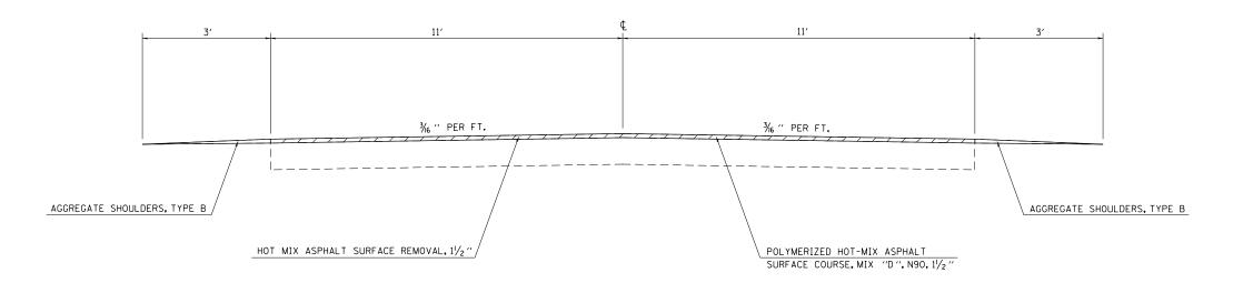
HOT MIX ASPHALT SURFACE REMOVAL, 11/2"
