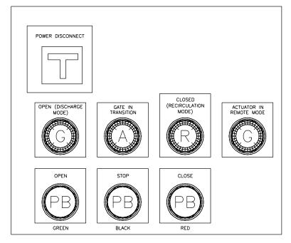
DISCHARGE GATE ACTUATOR - DG-1
