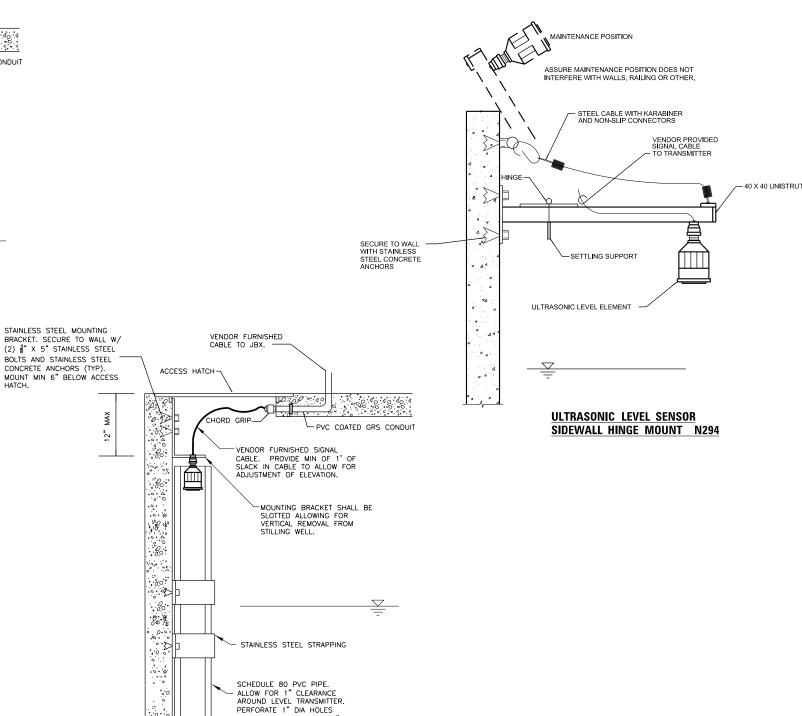
**ULTRASONIC LEVEL SENSOR** SIDEWALL STILLING WELL N295
