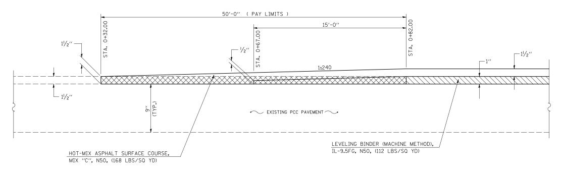
HOT-MIX ASPHALT SURFACE REMOVAL - BUTT JOINT
