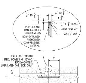
8 CONSTRUCTION JOINT DETAIL
