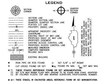
BT2 BURIED 5\8 INCH REBAR 20 INCHES BELOW GROUND TO TIE FOUND IRON STAKE BT3 IDENTIFIED BY COLORED PLASTIC CAP BEARING SURVEYORS PROFESSIONAL NUMBER
